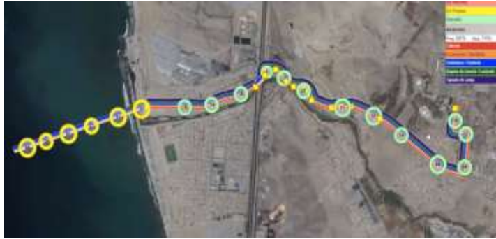
Trayecto de la tubería del emisor marino de la Central Térmica Ventanilla.
